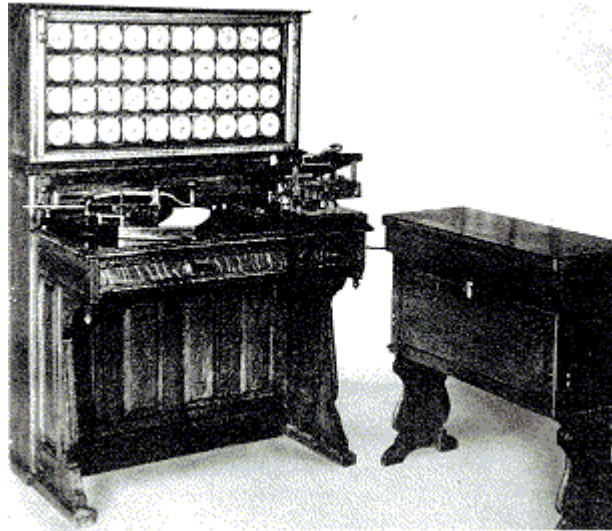
Tabuladora eléctrica de Hollerith, patentada en 1889.
